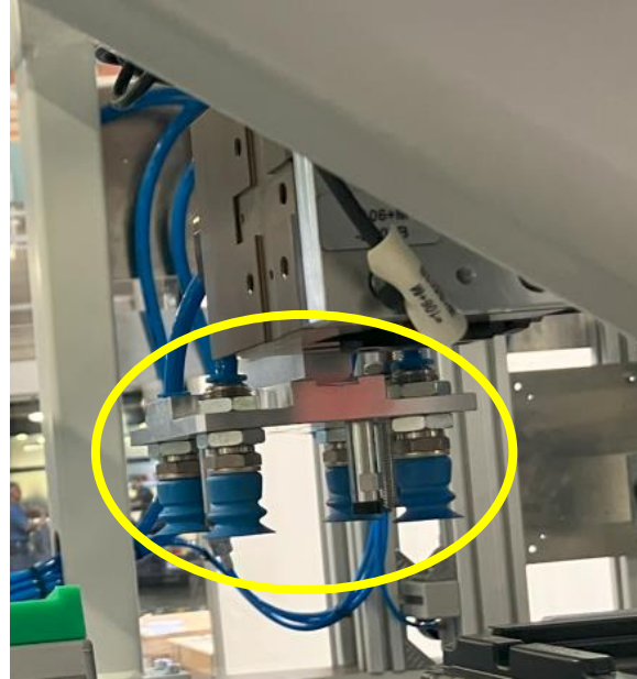
Vakuumgreifer für metallische Komponenten
