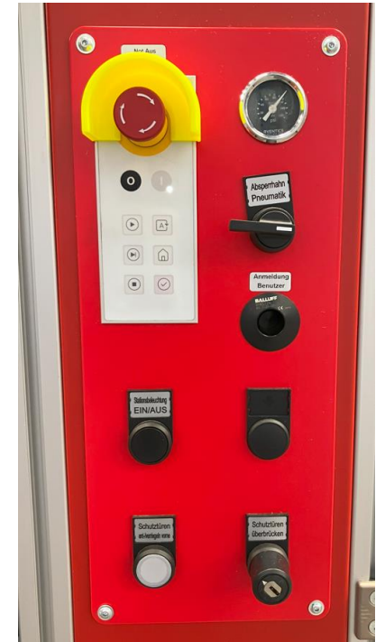
Hauptbediensäule mit eingeschränktem Funktionsumfang inkl. „easyPanel“
