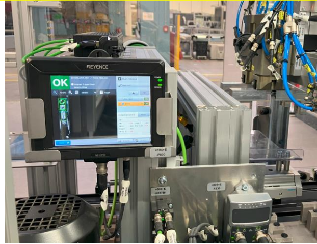
Keyence Kamerasystem zur Ermittlung der Orientierung der Zellen
