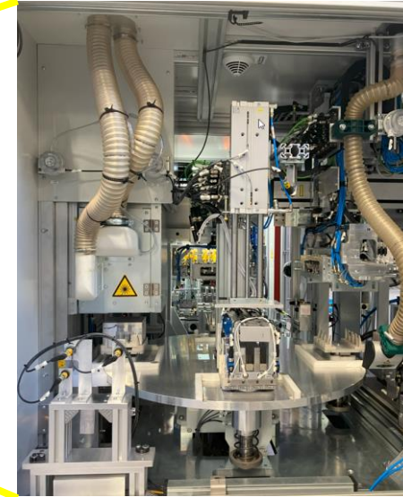
Innenansicht – Rundtisch mit 4 Arbeitsposition (Aufsetzten in Rundtisch – Laserstrukturieren – Prüfen der Laserstruktuirung – Entnahme aus Rundtisch)
