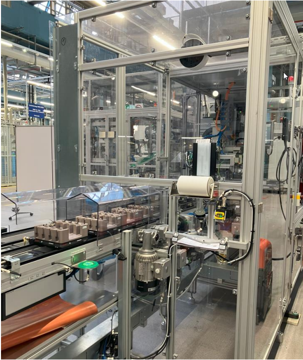
Manuelle Materialzuführung 4 Zellen je Werkstückträger
