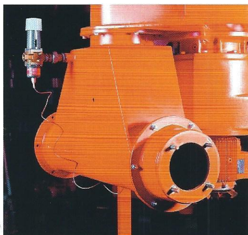
Flexible Anbindung zu Transportsystemen durch Einsatz von Drehflanschen
