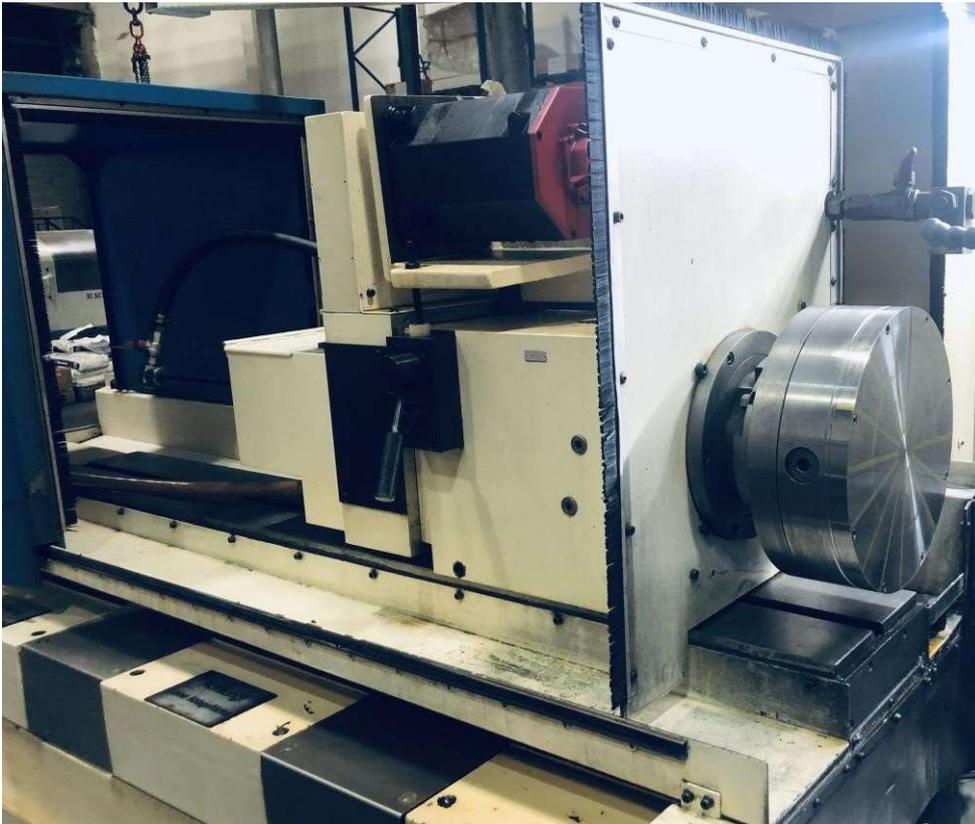
Werkstückspindel verschiebbar (1200mm) vordere Position
