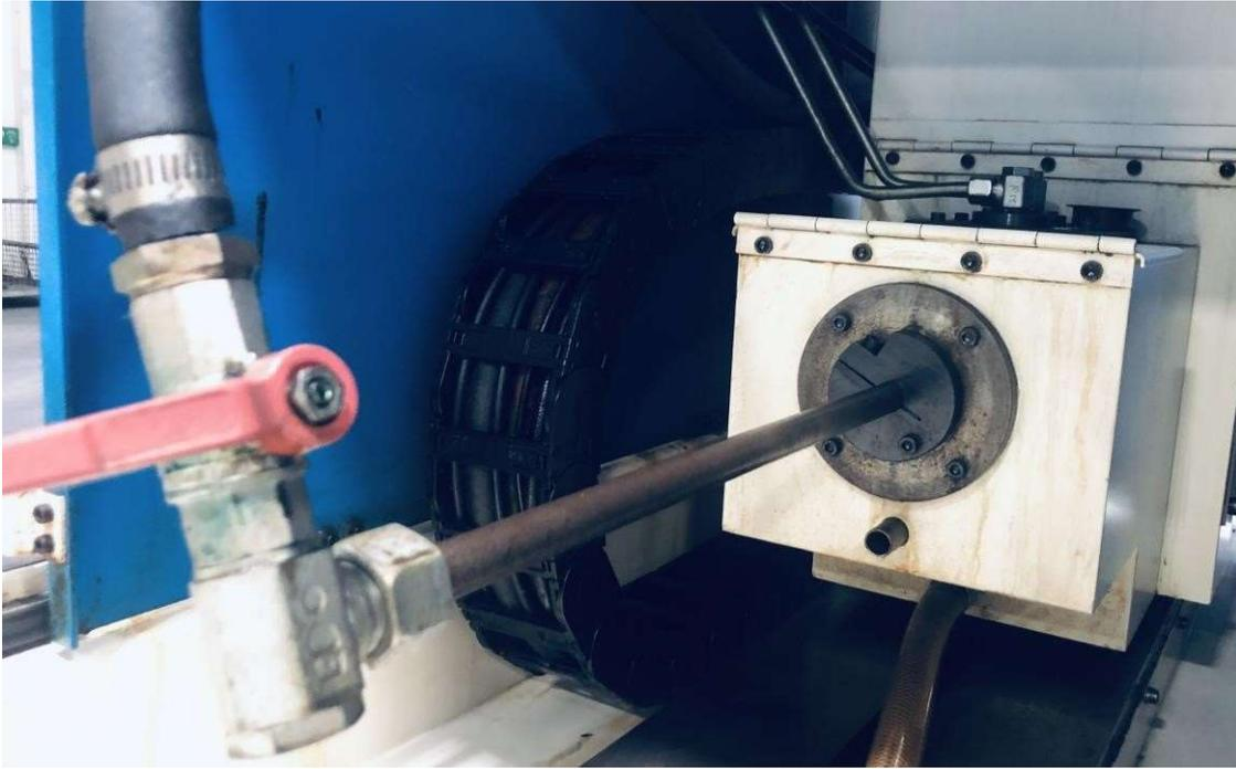
Hydraulische Spaneinrichtung für Kraftspannfutter
