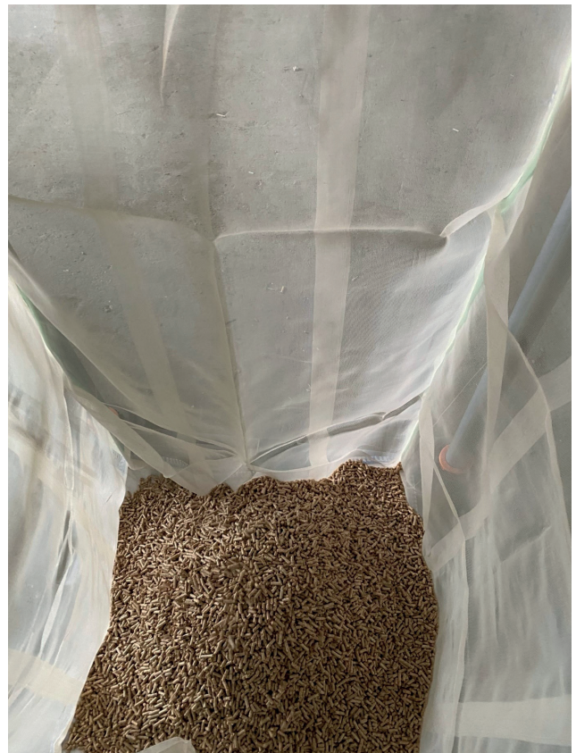
Abbildung 6 (L): Pellets fallen durch das Absacksystem in den Big-Bag.
