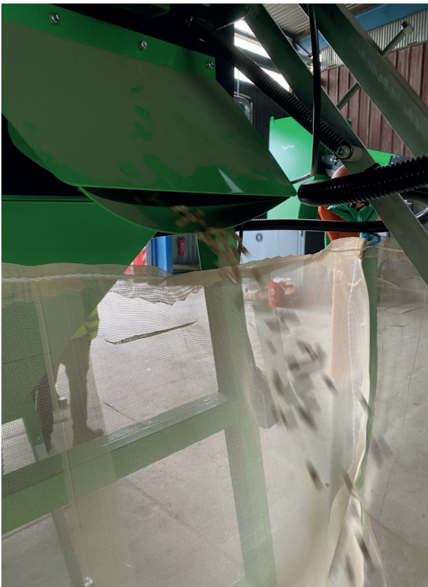
Abbildung 6 (L): Pellets fallen durch das Absacksystem in den Big-Bag.
