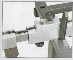
Der massive, schwenkbare Teleskopanschlag (Standard) ist mit einer hoch präzisen Einstelltechnik ausgestattet.
