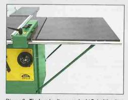
Die große Tischverbreiterung erlaubt Schnittbreiten bis 1250 mmzwischen dem Sägeblatt und Anschlag. Der Anschlag gleitet spielend über die gesamte Tischbreite auf der verchromten Anschlagführungsschiene.
