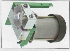
Im Detail das neu entwickelte und wirksame Vorritzaggregat (Kity geschützt)
