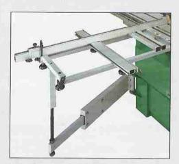
Der große verwindungssteife Auslegertisch ist rundsäulengeführt, ein Schnellspannsystem sorgt für das leichte Verschieben und Abnehmen des Auslegertisches in jeder Stellung.
