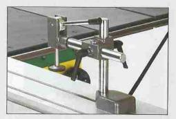
Dermassive Exzenterspanner sichert das Schnittgut auf dem Besäumschlitten und ist über die ganze Schlittenlänge verschiebbar.
