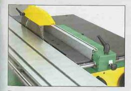
Ein abweichfrei geführter Längsanschlag (Standard) mit seinem robusten Exzenterspannsystem und mikrometrischer Feineinstellung. Die 800 mm lange Aluanschlagschiene ist wend - und verschiebbar, die neue magnetische Maßskala ist sekundenschnell justierbar.
