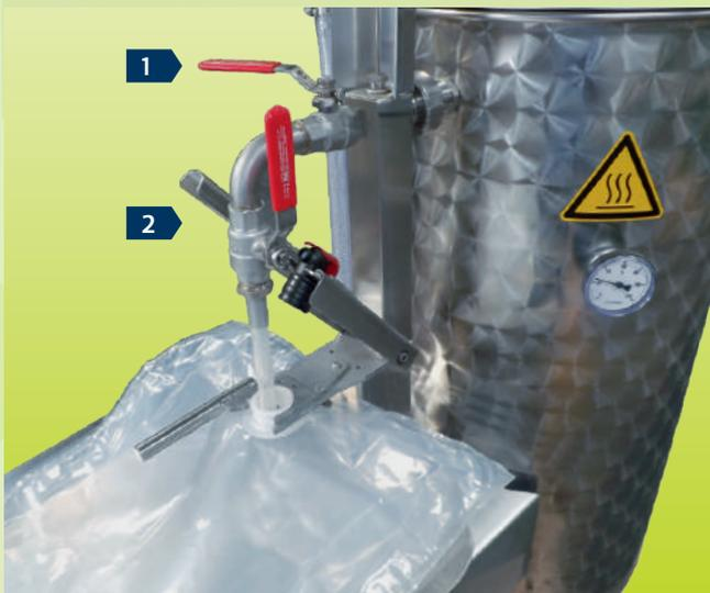
**1 Abfüllung in Flaschen:** Durch einen Kugelhahn wird über die Durchflussmenge die Pasteurisiertemperatur geregelt. Füllstart- und -stopp erfolgt bei Platzierung und Entnahme der Flaschen durch selbsttätige Ventile.
