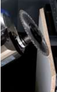
Auerisfreie und präzise Gehrungsschnitte und Fräsen schräger Nuten für eine Plattenverbindung
