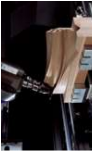
Fräsen eines Treppen-Handlaufs
