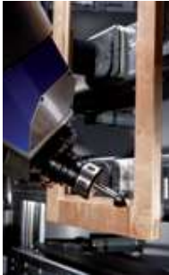
Eckiges Ausspitzen einer Glasfaser-Ecke
