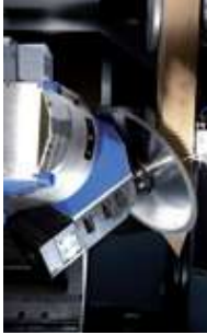
Schlitzschnitt mit großer Schnitttiefe für Rahmentelle
