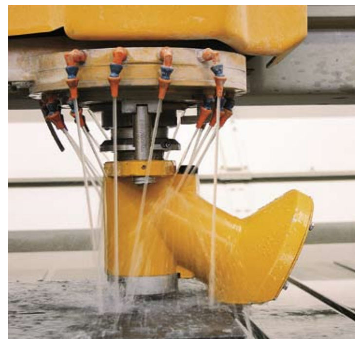
Unité de coupe avec disque incliné à 45° Cutting unit with 45° inclined blade
