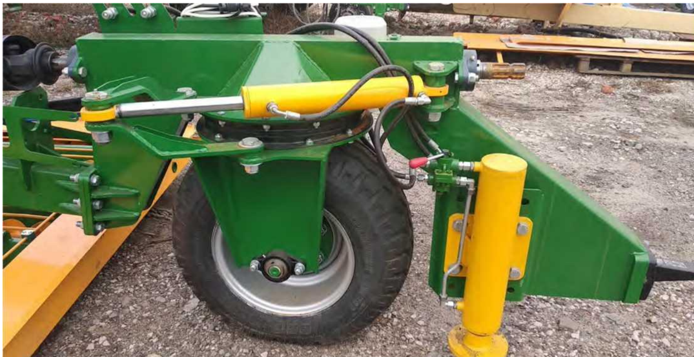
(Obr. 5.1 - Predné koleso s hydraulickým pohonom a elektrickým pohonom)
