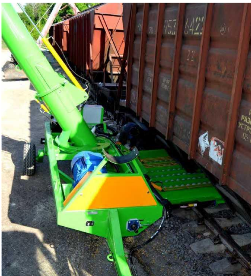
(Obr. 3 - Vykladanie vagónov - stôl by mal ležať na koľajnici presne v horizontálnej polohe)
