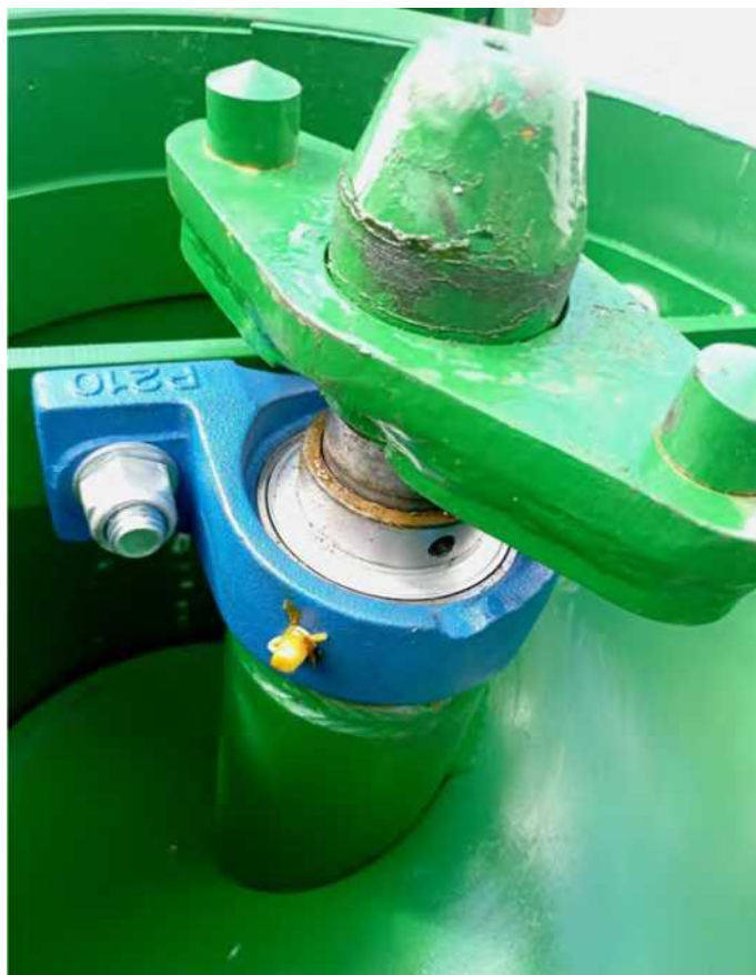
(Obr. 13. - Ložisko s pružinovým tlmičom a vodiacim kužeľom)
