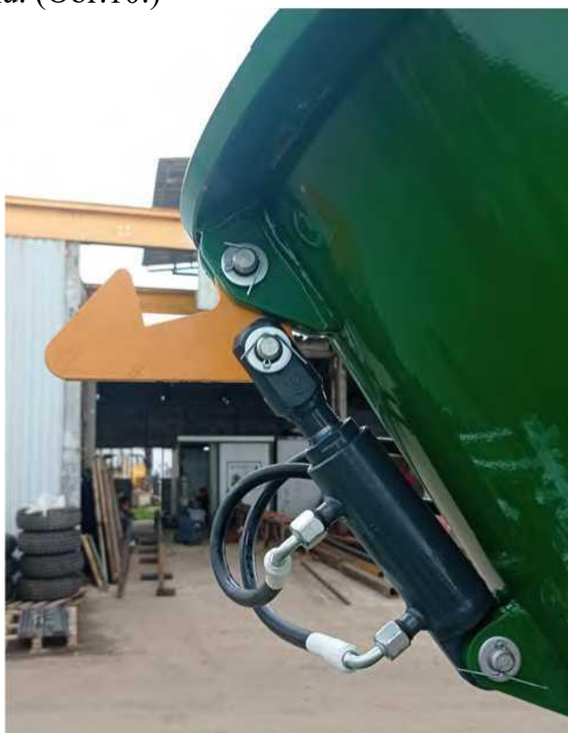
(Obr.10. - Hydraulický valec a fixátor (zámok) vertikálneho vykladacieho šneku.)
