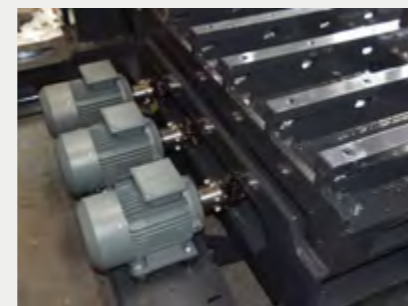
Otomatik Yağlamalı, Şaftlı Bağlantılı Vibrasyon Sistemi Automatic Oiled, Shaft Connected Vibration System
