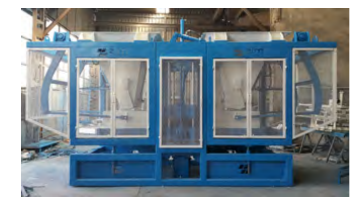
Cezayir - ZIM 820 Beton Parke ve Blok Üretim Tesisi Algeria - ZIM 820 Concrete Pavers and Block Production Facility
