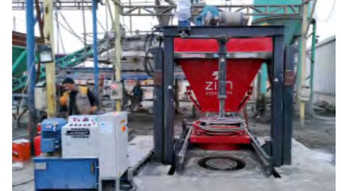
Türkiye - ZIM T 815 Beton Boru Üretim Tesisi Turkey - ZIM T 815 Concrete Pipe Production Facility
