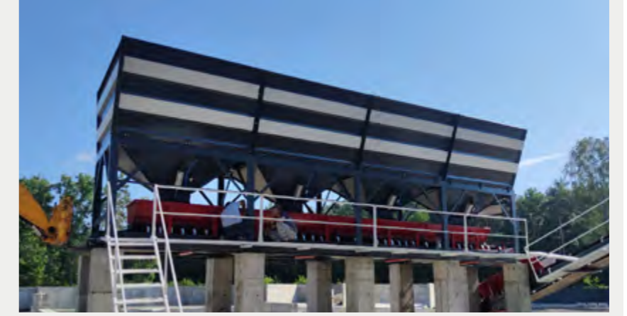
4x15 m3 Kum Bunkerı 4x15 m3 Sand Bunker
