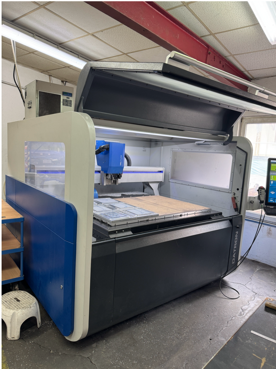
Datron MLCube – Außenansicht mit geöffneter Schutzhaube
