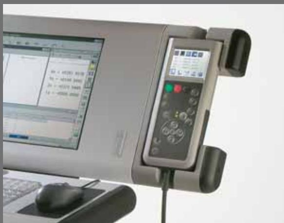
Die Handsteuerung erleichtert mit den wichtigsten Steuerfunktionen und einer grossen LCD-Anzeige alle Phasen des Einrichtens.
