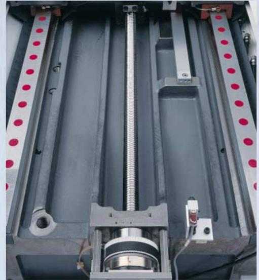
Kugelumlaufspindeln und stark überdimensionierte Achsführungen
