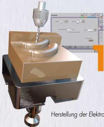
Herstellung der Elektroden
