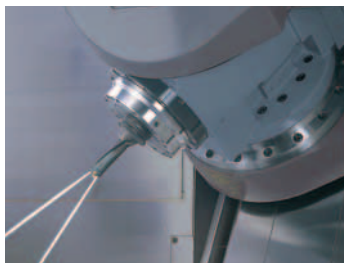
Kühlmittelzuführung durch die Spindel (Werkzeugspindel)
