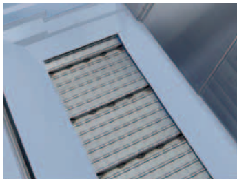
Späneförderer extern (Abfuhr nach rechts) <Scharnierbandförderer>
