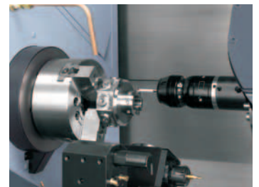
Internes Werkstückmeßsystem* 7 (Werkzeugspindel)
