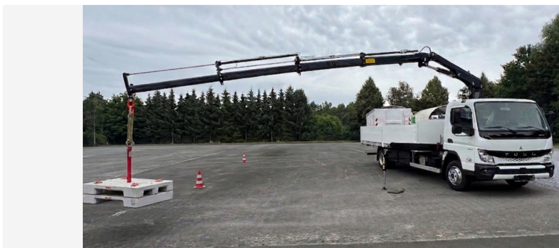
Ladekran HC 80 A3 voll ausgefahren inkl. hydraulischer Abstützung im Einsatz
