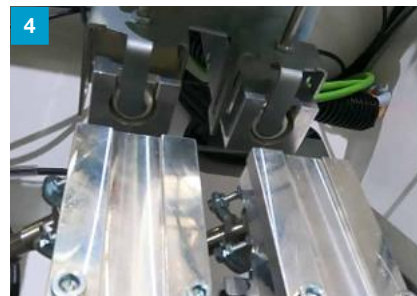
Übergabe der Verbinder an das Beschlagsetz-Aggregat
