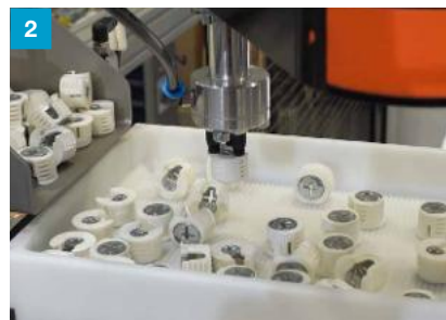
Die Rüttelplatte dreht die Verbinder in die korrekte Lage
