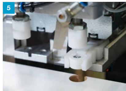
Einpressen der Verbinder in die vorgebohrte Position mittels Stempel
