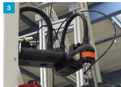
Der Roboter vereinzelt die Verbinder und füllt die Magazine an der Maschine
