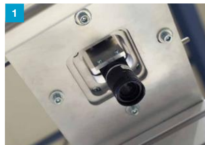
Ein Kamerasystem erkennt und prüft die Lage der Verbinder
