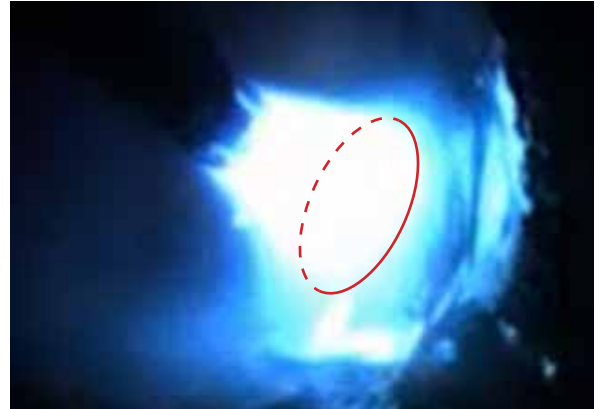
Jetzt: FOCUS.ARC Schweißprozess Konzentrierter Lichtbogen mit Energie im Zentrum
