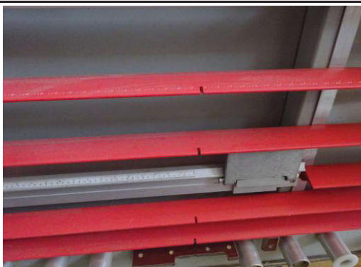
Anlegeleisten mehrfach eingeschnitten
