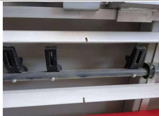
Anlegeleisten mehrfach eingeschnitten
