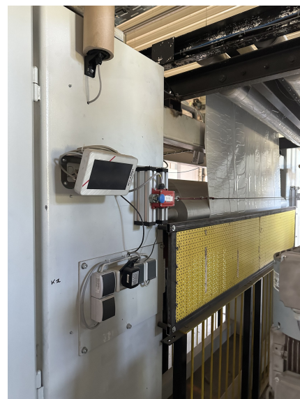
Schutzgitter und Sensorik am Warenlauf
