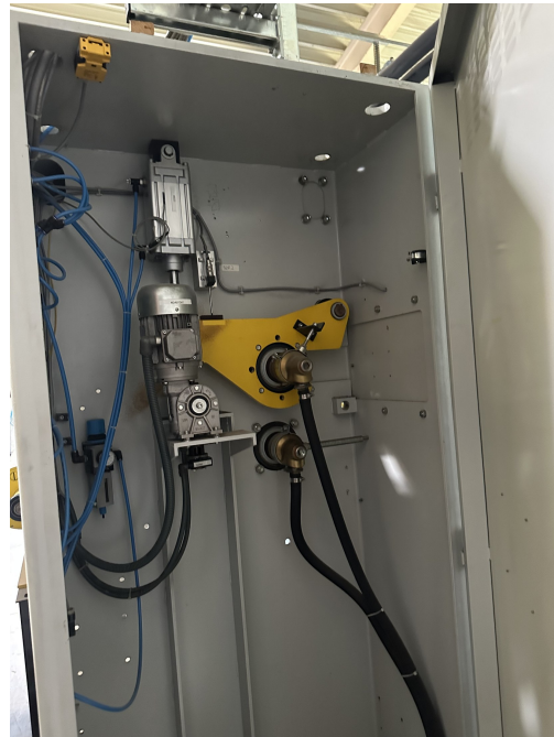
Motor-/Getriebeeinheit, Stellmechanik und Medienleitungen
