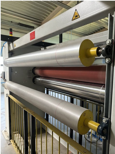
Walzenpaket mit Metall- und Elastomerwalzen
