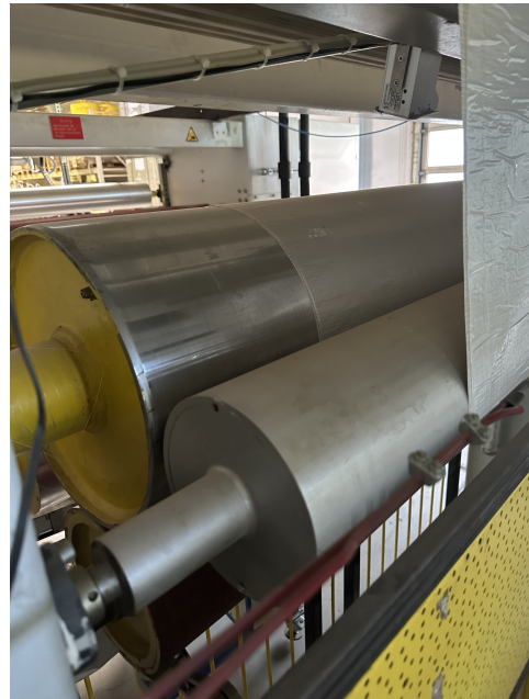
Walzensystem und geschützter Einzugsbereich
