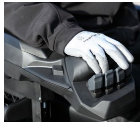
Hydraulische Fingertipp-Steuerungen (optional)
