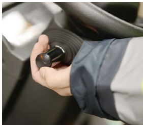
Fahrtrichtungshebel am Lenkrad (optional)
