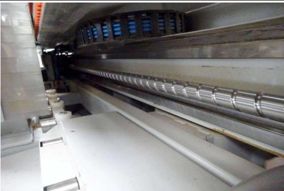
Ansicht Verfahrweg Bohraggregat
