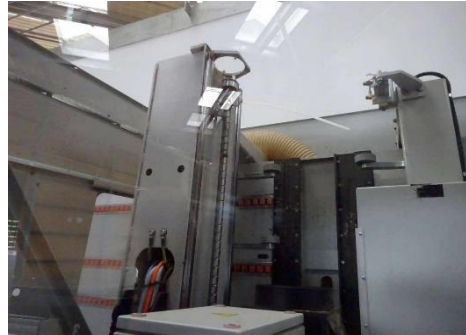
Ansicht Aufnahme Bohraggregat
