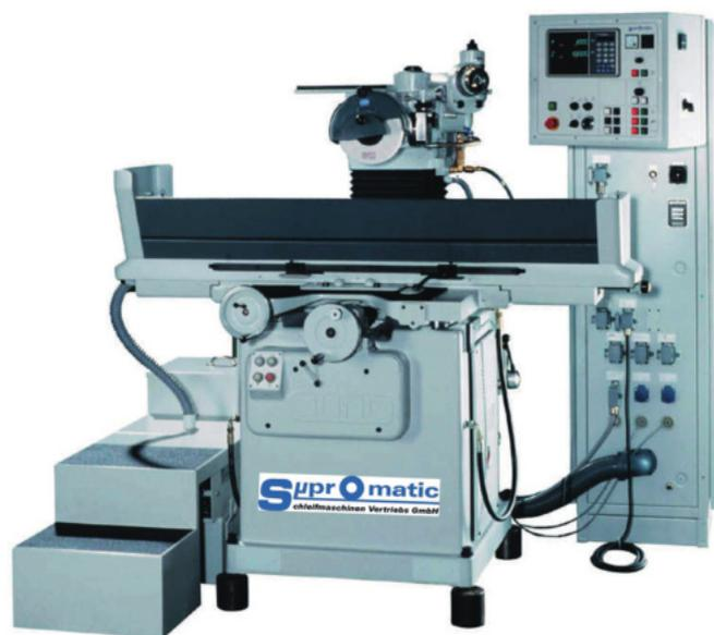
Generalüberholte JUNG HF 50 mit modernisierter Steuerung
