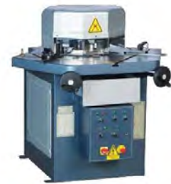
Auslinkmaschine mit variablem Winkel
