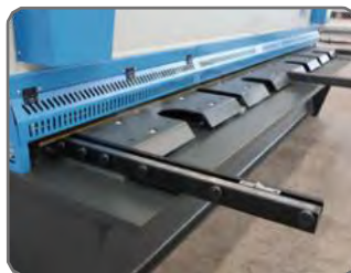
Square Auflegearm mit 1000mm Skala und Flip
