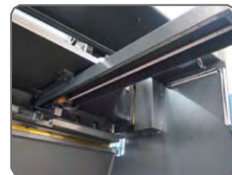
Hinteranschlag mit Linearsystem
