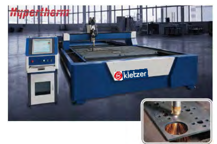
CNC Plasma- und Brennschneidanlagen für eine breite Palette von Baustahl, Edelstahl und Aluminium
