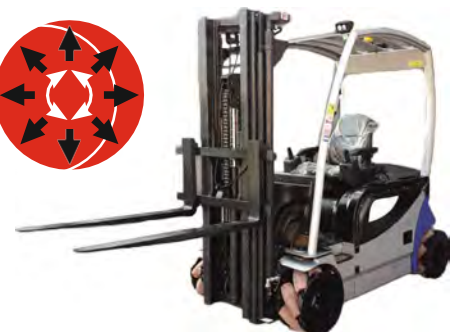
Elektrogabelstapler (mit Mecanum-Rädern oder Gummibereifung)
