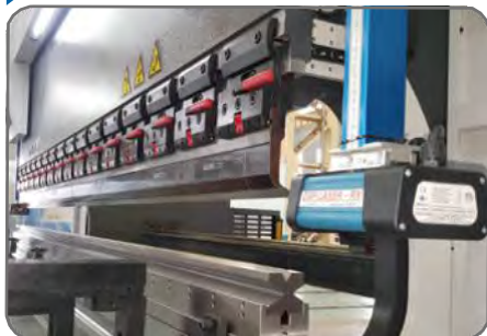
CE –konform mit Laserschutzvorrichtung
