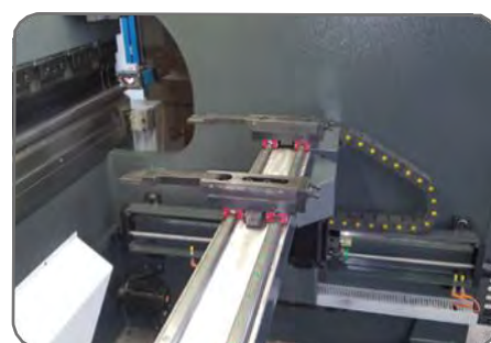
Hinteranschlag mit Linearführung
