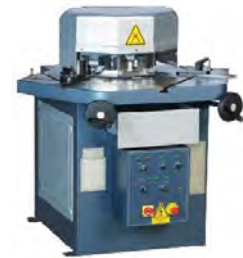
Ausklinkmaschine mit variablem Winkel
