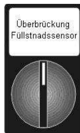
Abbildung 10: Drehschalter Überbrückung Füllstandssensor
