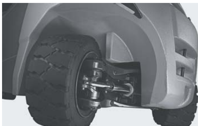
Zwrotny i stabilny dzięki osi skrętnej z wahliwym ułożyskowaniem
