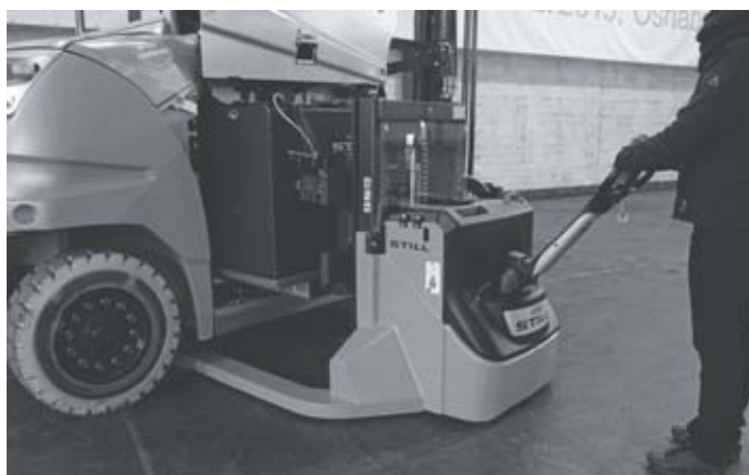
Szybka wymiana baterii wózkiem podnośnikowym ECU 30 Special
