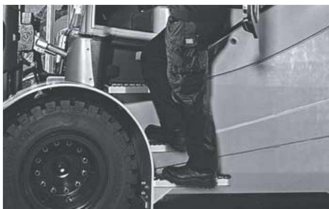
Bezpieczne wsiadanie i wysiadanie z wózka dzięki stopniom widocznym z góry i o dużej przyczepności
