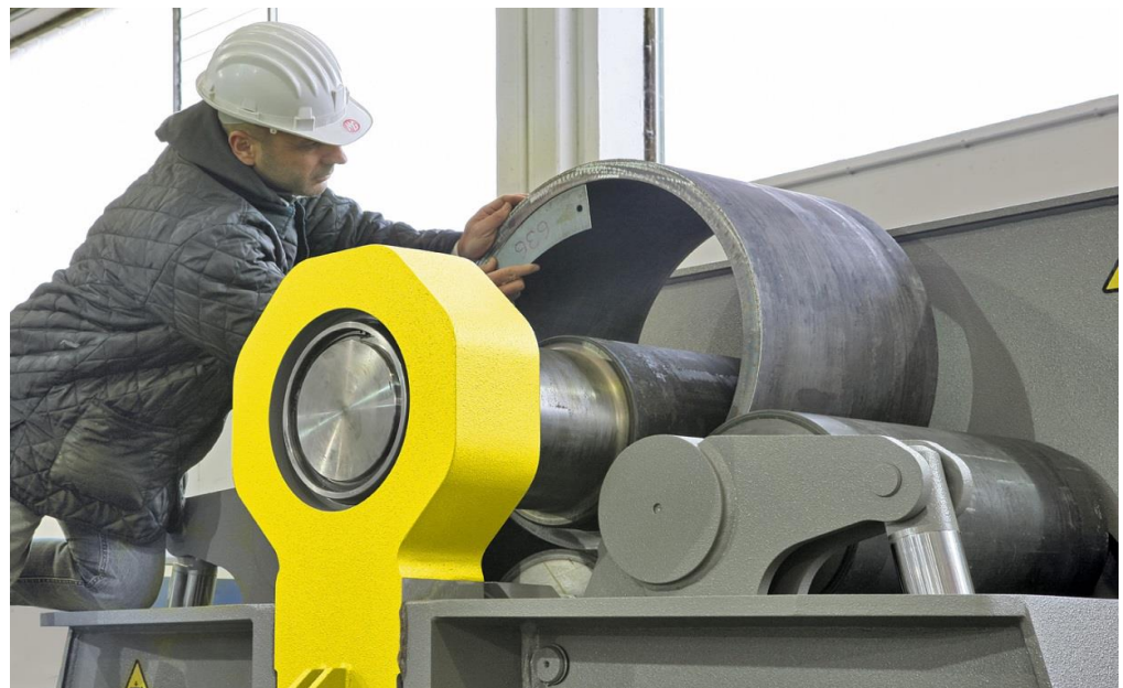
3-Walzen mit variablen Achsen
