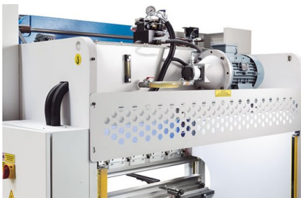
Das Hydraulikaggregat befindet sich oben auf der Maschine und bietet zusätzlichen Biegeraum
