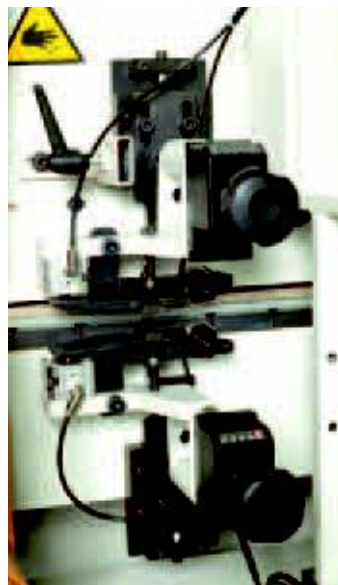
Scraping unit Groupe racleur de fil Ziehklänge Entfernt überstehende Kanten
