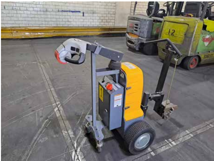
Lote 1: Remolcador eléctrico (TUGGER) Marca VESTIL , Modelo TX100 , Capacidad de 2,000 Lbs aprox
