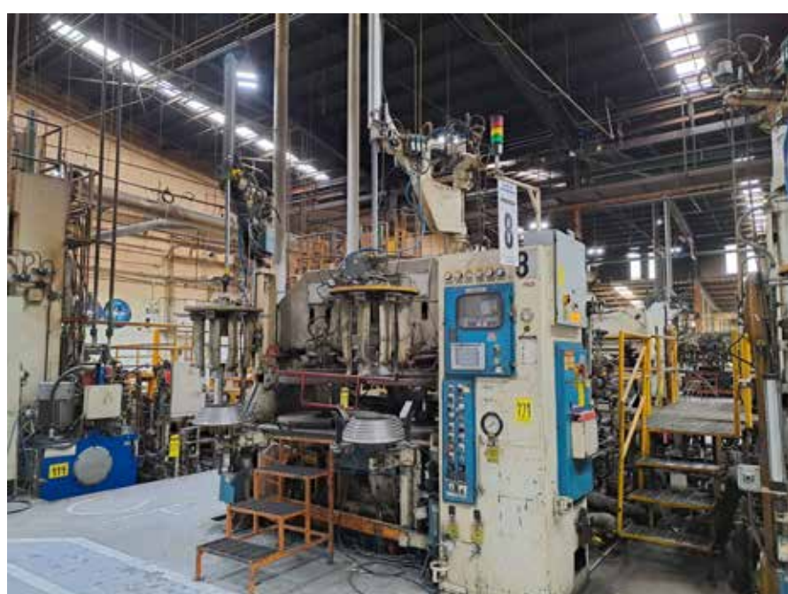
Lote 121: Prensa de Vulcanización a vapor Marca MC NEIL AKRON, Modelo 300-4215PM-16, Serie BP708555277, con presión máx de 300,000 lbs, Fuerza de Cierre Mecánico: 300 Toneladas, Tamaño Nominal de Platos: 42"
