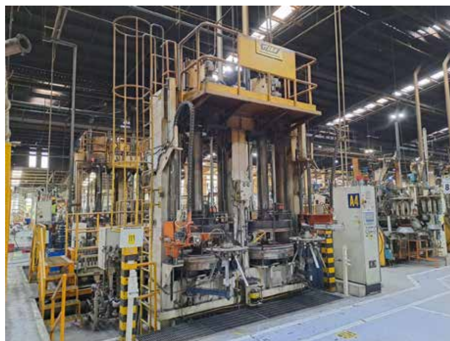
Lote 119: Prensa Hidráulica de curado de neumáticos a Vapor Marca GUILIN RUBBER MACHINERY FACTORY, Producto No. 20061004, Serie GUL4, Año 2006
