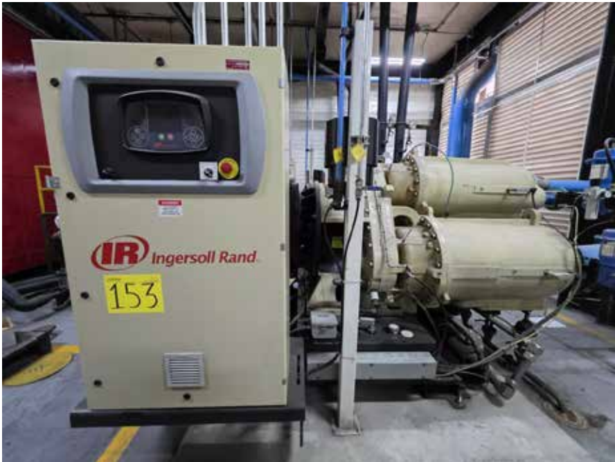
Lote 153: Sistema de enfriamiento de aceite para compresor Incluye intercambiador de calor Marca GIRESA, Modelo GHTS-442
