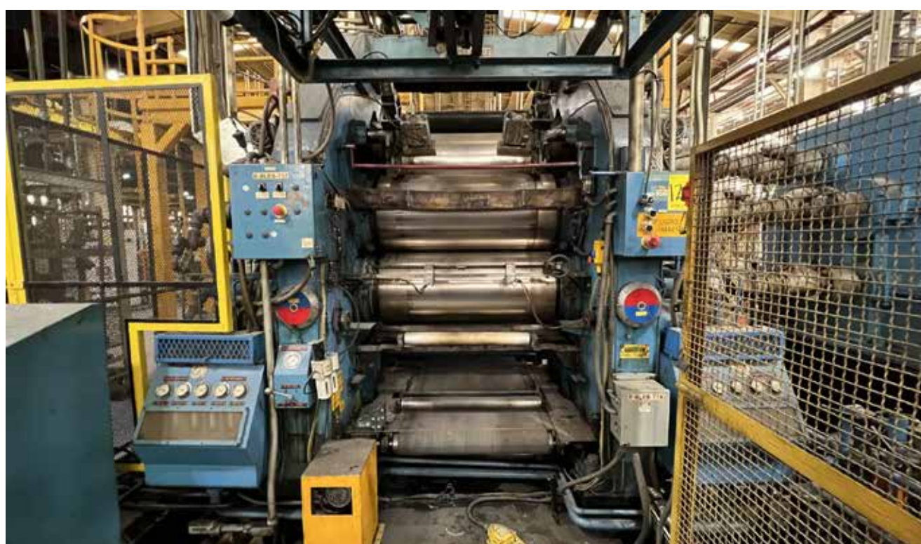
Lote 122: Maquina laminadora de hule de 3 pasos, consta de calandria de rodillos de acero inoxidable Marca COMERIO ERCOLE, con complemento TCU sistema de calentamiento de rodillos a base de agua Marca BUDZAR.
