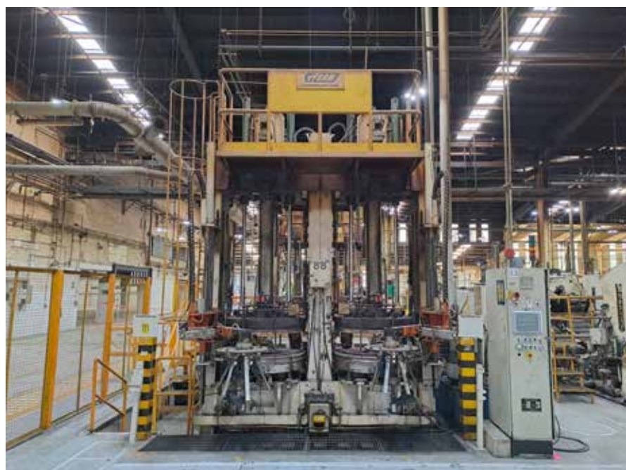
Lote 119: Prensa Hidráulica de curado de neumáticos a Vapor Marca GUILIN RUBBER MACHINERY FACTORY, Producto No. 20061004, Serie GUL4, Año 2006
