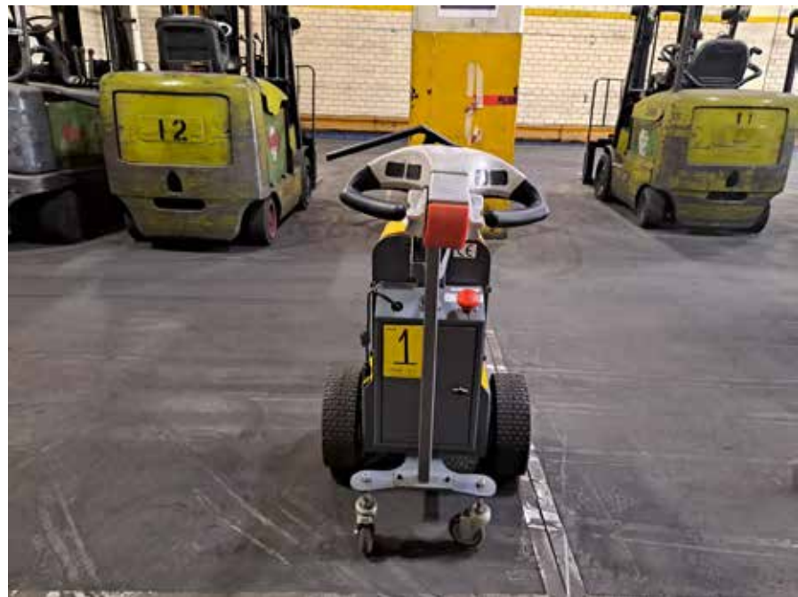
Lote 1: Remolcador eléctrico (TUGGER) Marca VESTIL , Modelo TX100 , Capacidad de 2,000 Lbs aprox
