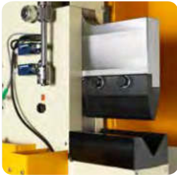
Mit den EU-Normen konforme, permanente Abkantstation.
