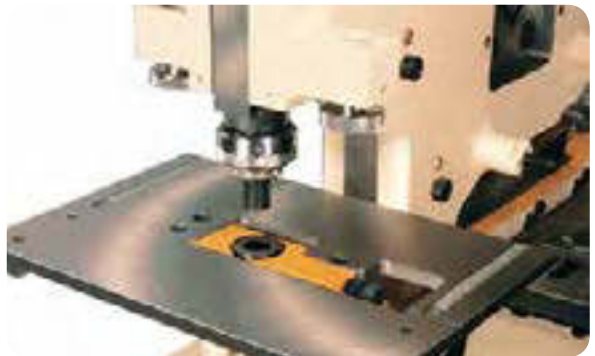
Matrizenhalter Schwanenhals zum Stanzen von Metallblech und Formstahl. Schnellspanneinrichtung.
