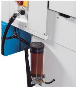
Zentralschmierung erleichtert Wartung
