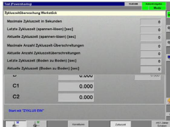
Anzeige der Werte der Zykluszeitüberwachung . Das Bild dient lediglich der Anzeige des aktuellen Standes der Maschine. Ein Eingeben oder Ändern von Daten ist hier nicht möglich.
