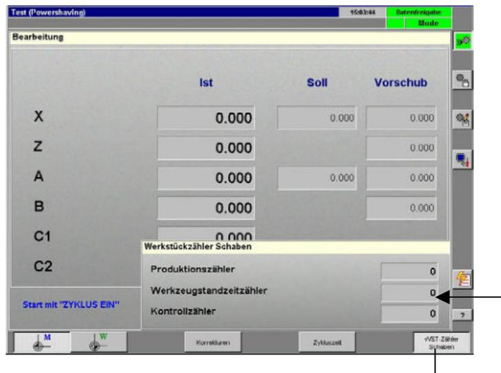
Anzeige der aktuellen Zählerstände für Produktion, Werkzeugstandzeit und Werkstückkontrolle der angewählten Datei
