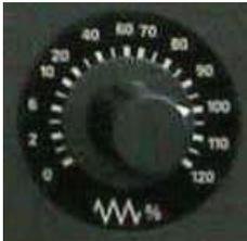
Vorschubgeschwindigkeit mit dem Override-Schalter einstellen; der Vorschubwert F wird in % am Bildschirm angezeigt.
