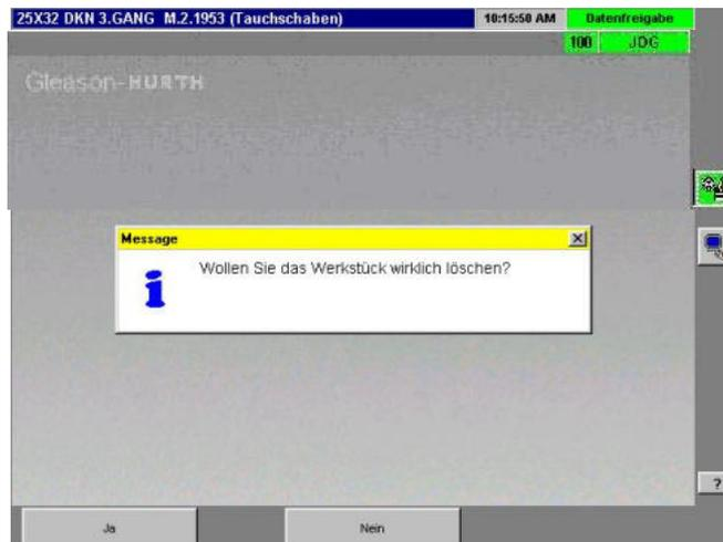
Zum Abbrechen des Löschvorganges Softkey nein betätigen.
