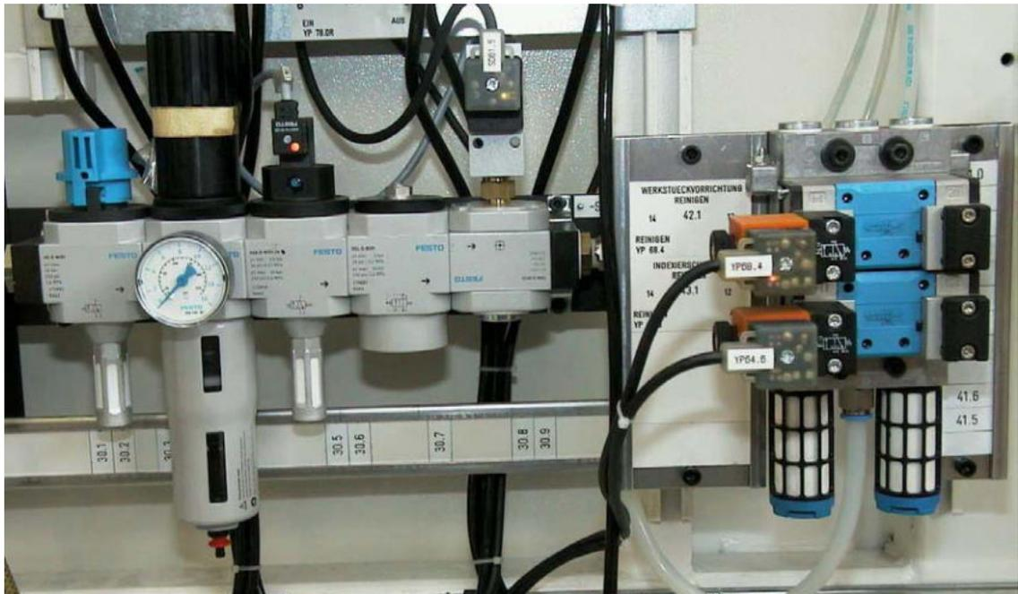
Das Pneumatikaggregat ist an der Maschinenrückseite angebaut.
