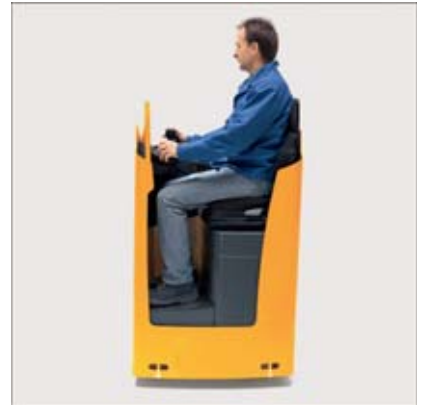
Komfortable Sitzposition mit höhenverstellbarem Bodenblech beim ESE 220/320
