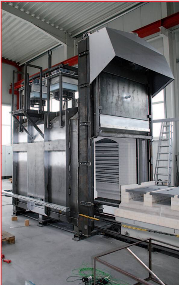
Herdwagenofen mit einsteckbaren Ventilatoren bis 800 °C
