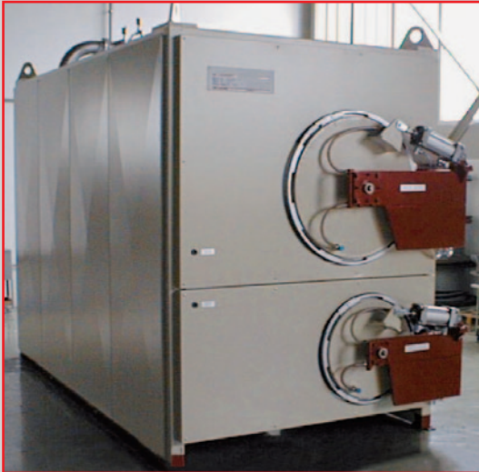
Vakuum-Doppelkammer-Anlassofen bis 750 °C
