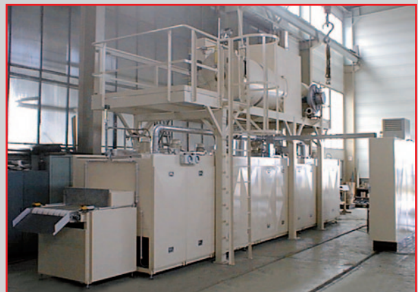
Durchlauf-Aushärteofen bis 250 °C
