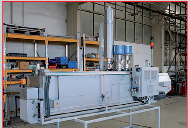
Durchlaufofen mit definierter Abkühlung und individueller Temperaturregelung
