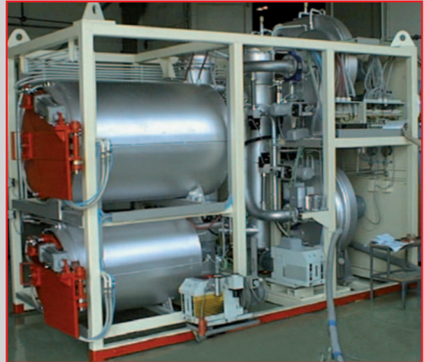
Vakuum-Doppelkammer-Anlassofen bis 750 °C (offen)
