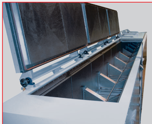
Blick in den Nutzraum eines Truhenofens
