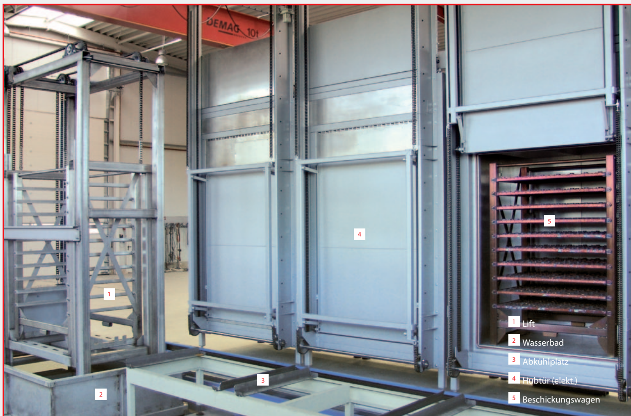
Vergüteanlage bis 550 °C
