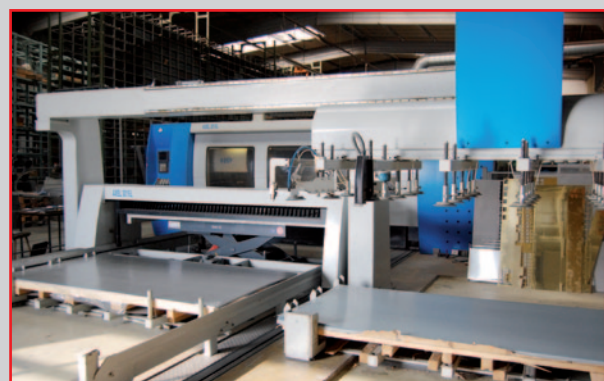
Laserschneideanlage – vollautomatische Materialzufuhr
