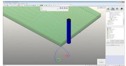
POSITIONIERUNG AUF DEM MASCHINENTISCH MIT UEBERPRUEFUNG VON KOLLISION
