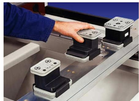
EINFACHE VORBEREITUNG DES ARBEITSTISCHES DURCH BELIEBIGES VERSCHIEBEN DER SCHLAUCHLOSEN SAUGER
