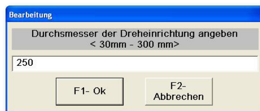
Abb. 43. Eingabe des Rohrdurchmessers beim Aktivieren der RSV
