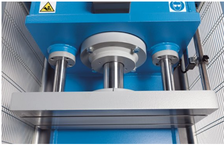
Zwei Rundführungen gewährleisten die Parallelität der Stößelplatte während der Hubbewegung
