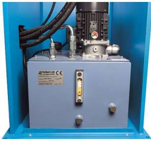
Das Hydrauliksystem ist platzsparend aber gut zugänglich im Gestell eingebaut
