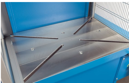
Diagonal ausgerichtete Nuten erleichtern die mittenzentrierte Aufspannung der Werkzeuge
