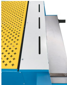
Schwenkbare Arbeitsraumabdeckung für die Sicherheit des Bedieners
