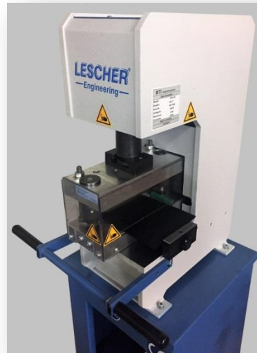
Hydro-Pneumatik Stanze Modell HPS-120 incl. Untergestell und Stanzwerkzeug
