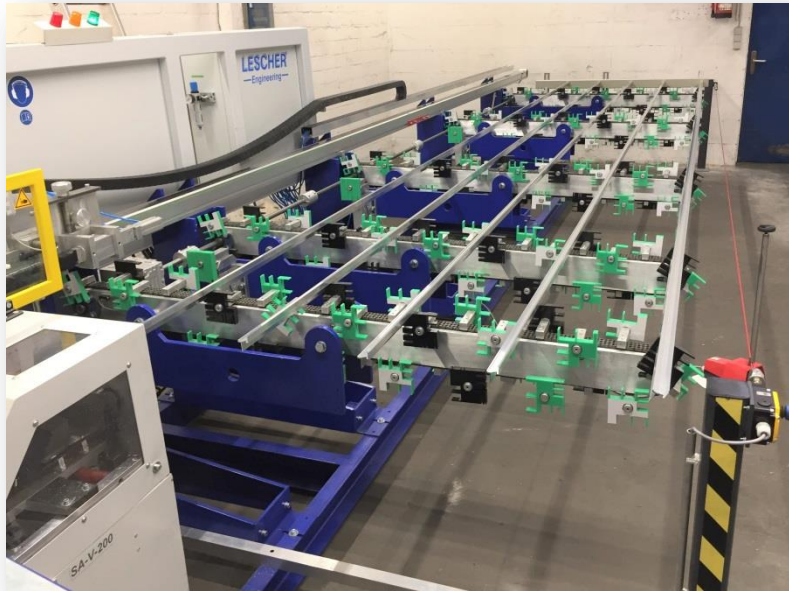
Querfördersystem mit Profilauflegebacken und bis zu 17 Vorladeplätzen
