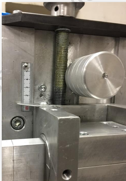
Pushersystem mit Haltezange zur Aufnahme von bis zu zwei Profilen
