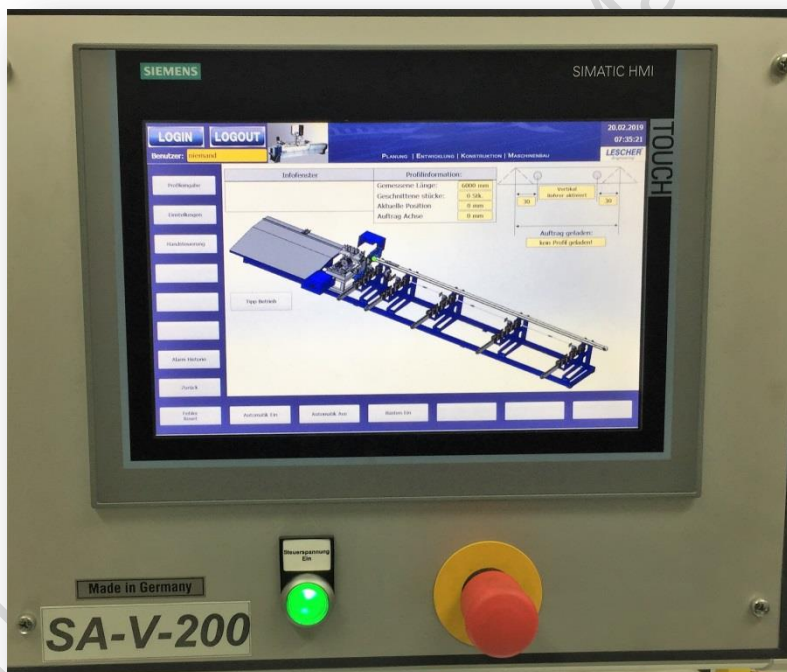
Querfördersystem mit Profilauflegebacken und bis zu 17 Vorladeplätzen
