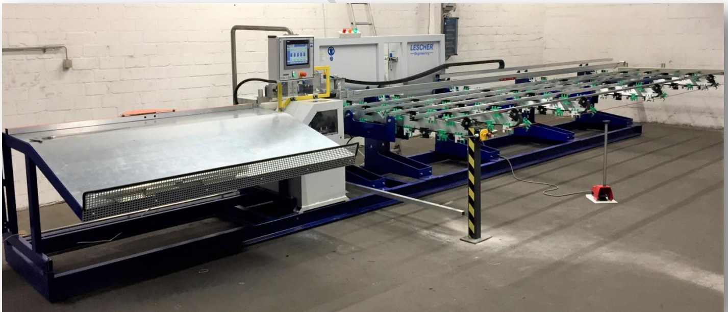
Bohr-/Sägezentrum Typ SA-V-200 V-Schnittsäge mit Querfördersystem
