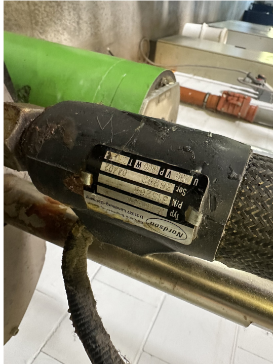
Abb. 4 – korrekt gedrehtes Nordson-Komponentenschild an einer beheizten Baugruppe
