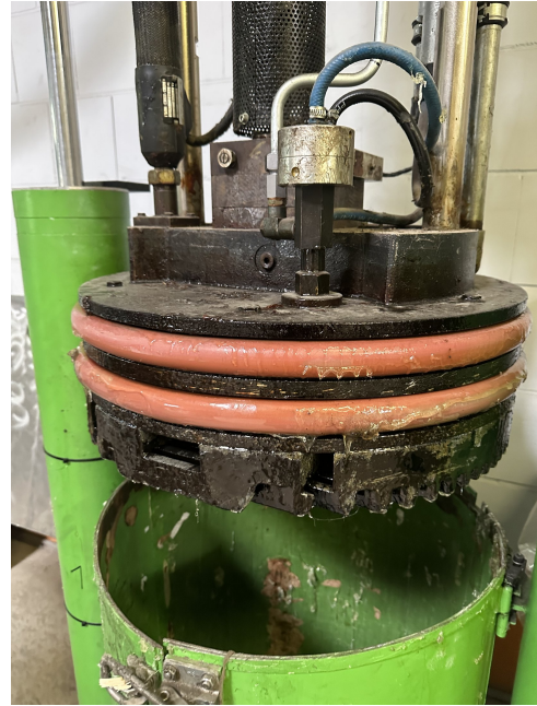
Abb. 3 – beheizte Druck-/Schmelzplatte mit zwei Dichtungsringen
