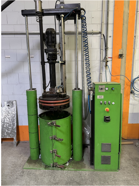
Abb. 2 – Gesamtaufbau mit Hubrahmen, Fassaufnahme und Schaltschrank A1
