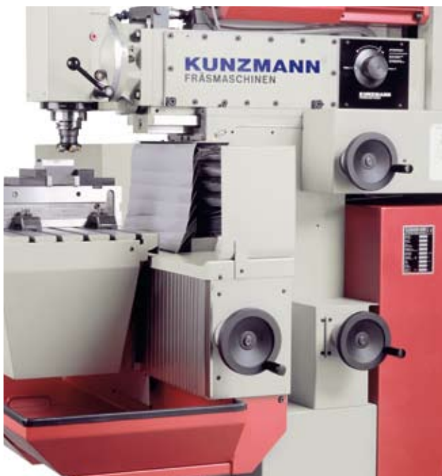
Ergonomisch angeordnete Sicherheitshandräder zum manuellen Verfahren
