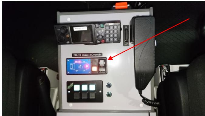
Grundvoraussetzung für die Luftfederung ist die Aktivierung der Handbremse sowie die Stellung des Schalthebels auf P.
