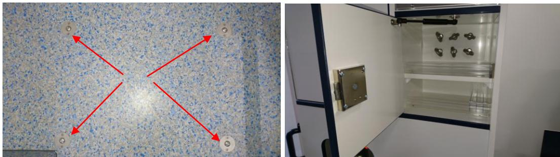
In die Gewindegülsen können im Notfall die mitgelieferten Ringschrauben montiert werden, welche im Schrank unter dem Medikamentenkühlschrank mitgeführt werden.
