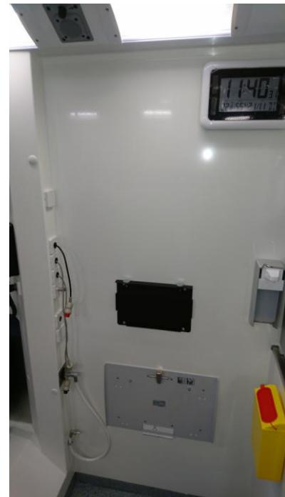
In der rechten Seitenwand vor dem Radkasten ist ebenfalls eine Verstärkung eingearbeitet worden, sodass ein Schienensystem, bestehend aus 2 senkrechten Airline-Schienen sowie 3 verstellbaren Einzelschienen mit Rändelmuttern montiert werden konnte. Eine Einzelschiene ist mit jeweils 15kg belastbar.
