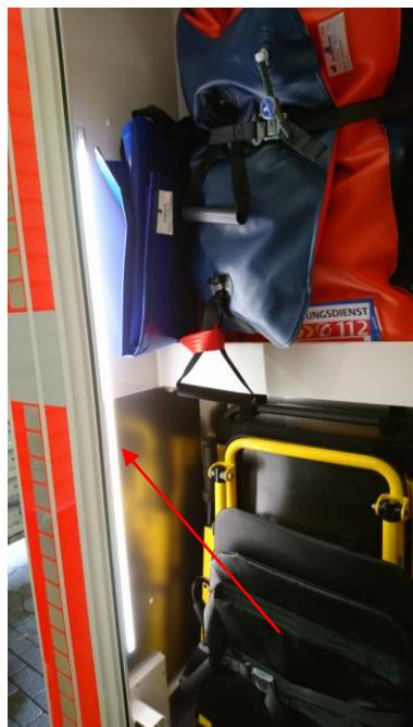
Das Außenstaufach hinten links, in welchem die Sauerstoffflaschen untergebracht werden, ist ebenfalls mit einer LED-Beleuchtung ausgestattet, welche über den Türkontakt eingeschaltet wird.
