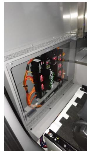
**Hinweis:** In der Zentralelektrik befinden sich eine prozessorgesteuerte Schaltlogistik, Zeitsteuerung und eine Unterspannungsüberwachung. Ein akustisches Signal signalisiert dem Anwender eine Unterspannung der Fahrzeug- bzw. der Zusatzbatterie. Ein Unterspannungsschutz bewirkt eine Abschaltung aller 12V-Verbraucher ab einer Unterspannung von 10,5V.
