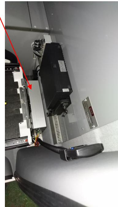
**Achtung** Die Belüftungsöffnungen am Ladegerät dürfen nicht verschlossen und abgedeckt werden.
