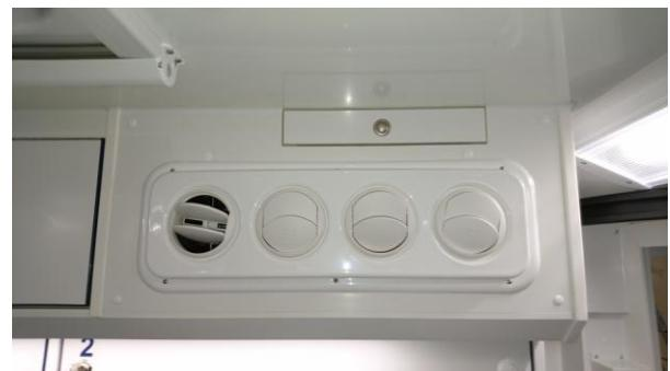
**Hinweis:** Die Klimaanlage ist mit einem darüber befindlichen Pollenfilter ausgestattet. Dieser ist regelmäßig zu reinigen. Sobald die Klimaanlage aktiv ist, wird über einen auf dem Kofferdach montierten Dachlüfter die Frischluftansaugung aktiviert, welche über den Pollenfilter gefiltert wird.
