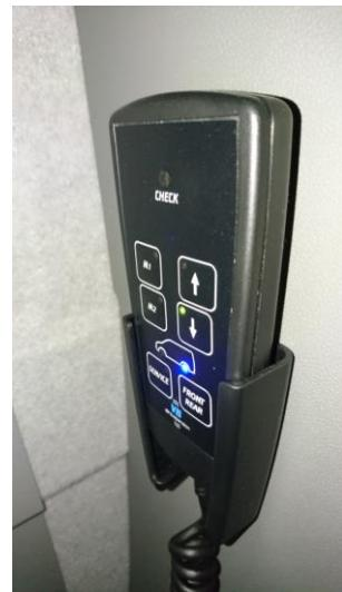
Sofern die Luftfederung nicht manuell wieder hochgefahren wird, geschieht dies spätestens beim Lösen der Handbremse.
