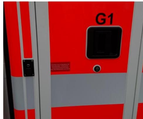
Bei aktiver 230 Volt Stromversorgung leuchtet über der Einspeisesteckdose eine grüne Kontrollleuchte und es wird eine Startsperre für den Fahrzeugmotor aktiviert. Die Aktivierung der Startsperre wird signalisiert durch einen dauerhaften Summtion, sobald der Zündschlüssel in die Stellung „Zündung“ gedreht wird.
