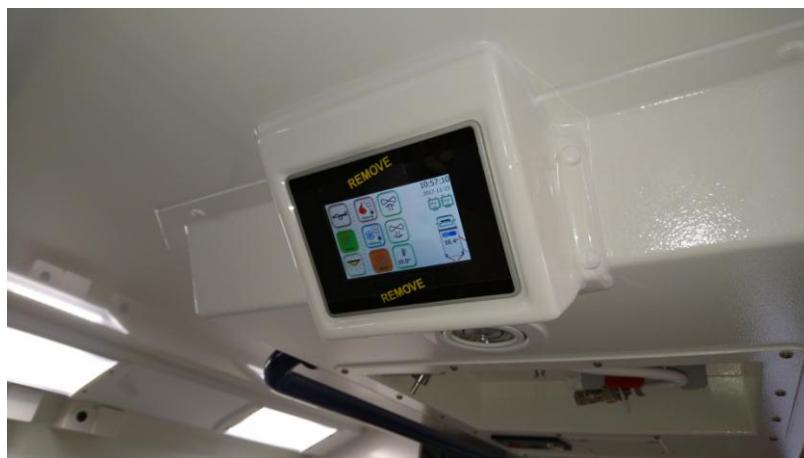
Ganz rechts auf dem Monitor werden in jeder Ansicht die Informationen über die Uhrzeit, das Datum, beide Batteriespannungen sowie über die aktuelle IST-Temperatur im Patientenraum dargestellt. Außerdem werden offene Türen vom Kofferaufbau angezeigt.
