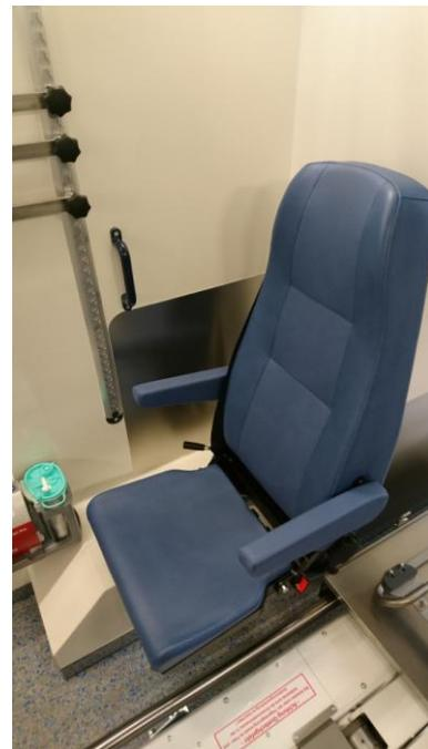
Die Sitzfläche ist ohne weitere Verriegelung ausklappbar und wird durch Gasdruckdämpfer im ausgeklappten Zustand gehalten. Optional können während des Betriebs die Armlehnen links und rechts vom Sitz genutzt werden.
