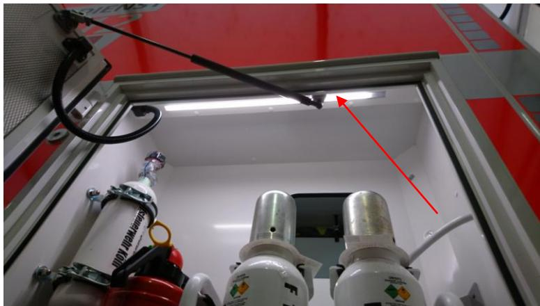
Vorne links in das Außenstaufach ist eine LED-Beleuchtung innen in den Schlosskasten eingearbeitet, sodass auch dieses Fach bei geöffneter Tür beleuchtet wird.
