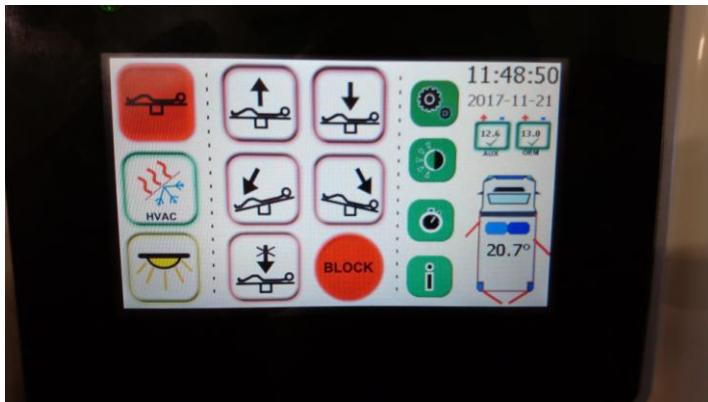
Die Auswahl „Ambulanztisch“ wird durch eine rote Hinterleuchtung bestätigt. Nach der ersten Auswahl können die verschiedenen Funktionen des Tisches durch Berühren der entsprechenden Icons angewählt werden. Hierbei ist zu beachten, dass das Icon gedrückt gehalten werden muss.
