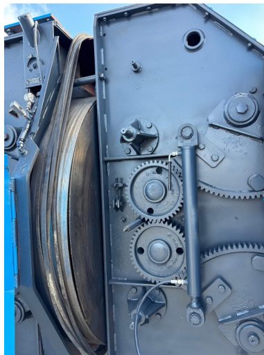
Detail der Entrindungswerkzeuge | Detail der Antriebskomponenten
