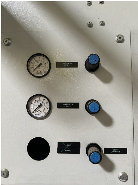
Abb. 4 – Druckregler und Manometer für Kalandrdruck links und rechts
