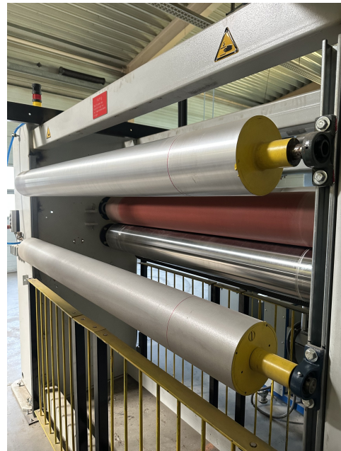
Abb. 5 – Walzenlagerungen und Einzugsbereich
