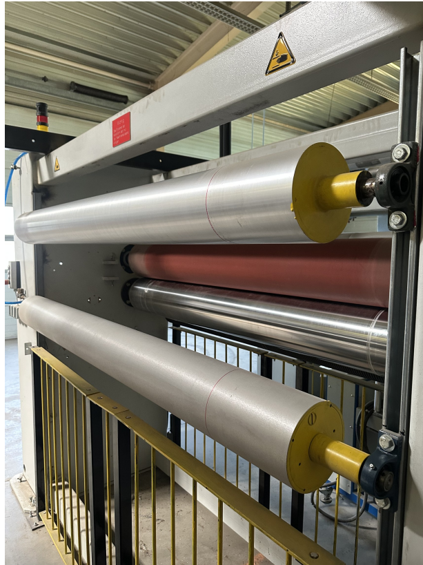
Abb. 1 – Walzenbereich eines der beiden baugleichen Cavitec-Kalander
