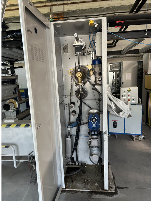
Abb. 6 – geöffnete Antriebsseite mit Ketten, Getrieben, Pneumatik und Drehdurchführungen
