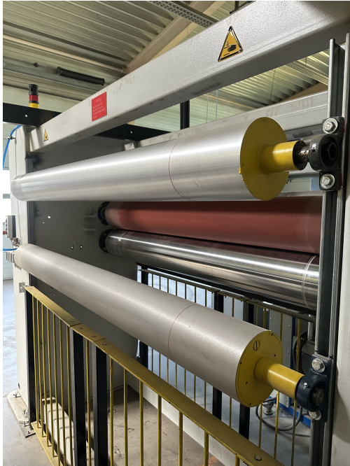
Abb. 2 – Walzenpaket mit glatten Metallwalzen und elastomerbeschichteter Presswalze
