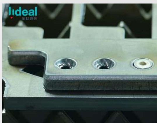
Herstellen von Senkbohrungen (6kW)
