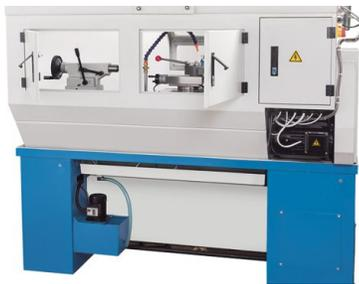
Der Arbeitsbereich ist über große Klappen auch von der Maschinenrückseite zugänglich
