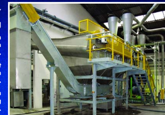
Schwimm-Sink-Tank mit Kratzkettenförderer
