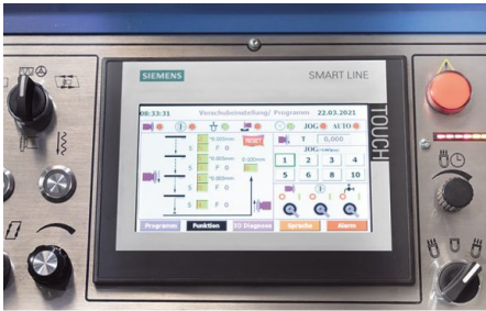
Alle notwendigen Parameter für die präzise Zustellung der Schleifspindel werden direkt am Siemens-Touchscreen erfasst und editiert
